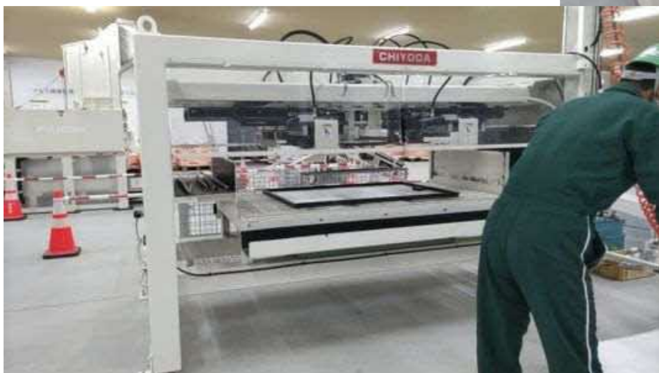
②表面のガラスを細かく砕いて分離する機械
