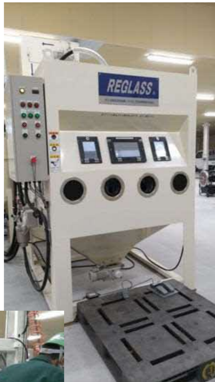
②表面のガラスを細かく砕いて分離する機械
